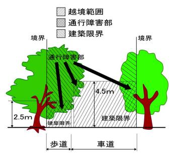
道路を安全に通行するため、一定の幅、一定の高さの 範囲内に通行の障害となるものを設けてはならない区域 として建築限界が定められておりますので、建築限界に はみ出した(図上の通行障害部の)樹木等の伐採にご協 力お願いします。
