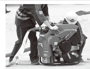
▲小型ポンプ 水を急速に吸い上げ、ホースによる放水を行います。
