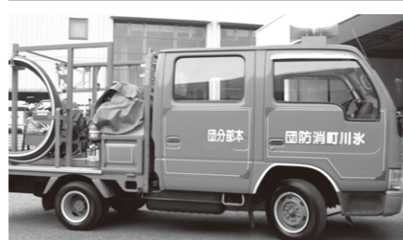
▲小型ポンプ積載車 小型ポンプを積載し、緊急現場への迅速な搬送を行います。
