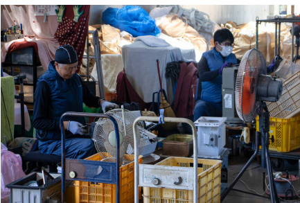
◀ クリーンセンターでの分別の様子。小型電気製品を分解して資源として使えるものを分けています。このように、ひとつでも多くのものを「ごみ」として捨てることなく「資源」として使えるように作業が行われています。
