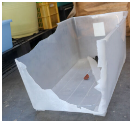
▲劣化した衣装ケース
